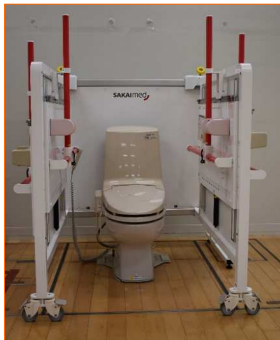
日常生活活動実習コーナー 手すり・床の高さ等変更できる動作支援設備
